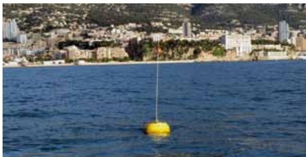
Cette bouée, véritable bijou technologique, est équipée d'un capteur GPS relié à une alarme, dans le cas où elle dériverait de son périmètre d'exploitation. Elle permet d'obtenir une connaissance précise du plan d'eau de la Principauté.
