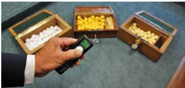
Les billes sont également contrôlées à l'aide d'un appareil. La bille est disposée sur l'appareil, si la lumière s'allume verte la bille est bonne, si la lumière s'allume rouge la bille n'est pas conforme. Les dés sont contrôlés par rapport à leur tolérance (poids) et l'usure des arêtes.
